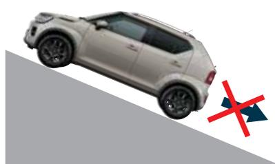
Bergabfahrhilfe reduziert automatisch die Geschwindigkeit auf 10 km/h:
