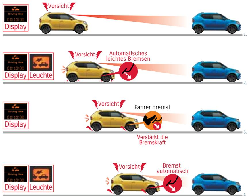
Bitte beachten Sie, dass die volle Funktionsfähigkeit des Dual-Kamera-gestützten aktiven Brems-systems nicht immer gewährleistet werden kann. Das System kann Auffahrunfälle verhindern bzw. die Stärke des Aufpralls erheblich minimieren, abhängig von den erkannten Gegenständen, Wetter und Straßenverhältnissen. Der Fahrer muss deshalb stets aufmerksam sein und selbst eingreifen.
