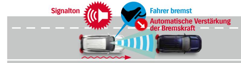
Aktiviert den Bremsassistenten zur Verstärkung der Bremskraft, wenn ein hohes Kollisionsrisiko besteht und der Fahrer eine Notbremsung einleitet.
