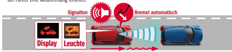
3. Eine automatische Notbremsung wird eingeleitet, falls das Kollisionsrisiko weiter steigt.
