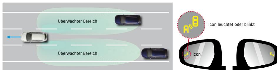
Ein Millimeterwellenradar überwacht die Seitenbereiche des Fahrzeugs und warnt den Fahrer vor Fahrzeugen im toten Winkel.
