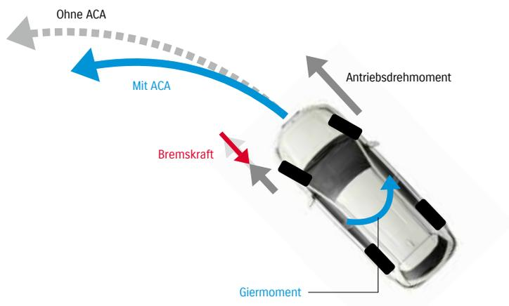
Der aktive Kurvenassistent (ACA = Active Cornering Assist) bremst die Innenräder in scharfen Kurven und hilft dadurch, ein Untersteuern des Fahrzeugs zu vermeiden.
