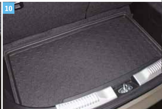
10 | Kofferraumwanne Passend für ALLGRIP mit verschiebbaren Rücksitzen Art.-Nr. 990E0-62R15-000 Passend für ALLGRIP oder Vorderradantrieb und starrer Rücksitzbank Art.-Nr. 990E0-62R15-001 Passend für Vorderradantrieb mit verschiebbaren Rücksitzen Art.-Nr. 990E0-62R15-002
